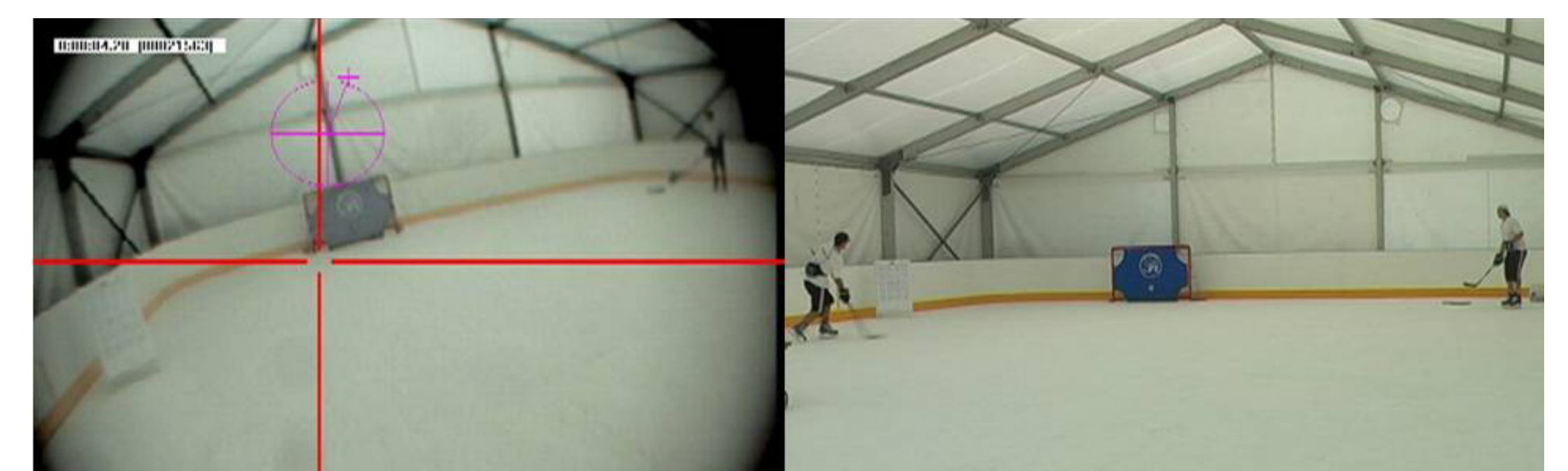
Abb. 2: Aufnahme des Eyetrackers (links) und Aussensicht eines Spielers (rechts) bei der Schussabgabe. Das rote Fadenkreuz gibt die Blickrichtung an.
