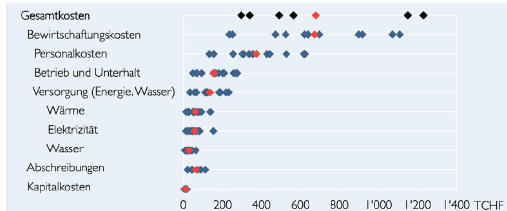
D 4.16: Streuung der Kosten bei Hallenbädern mit 25-Meter-Schwimmbecken
